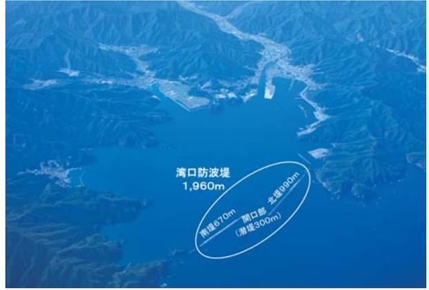
⑤⑥ 世界最大水深（-63m）に設置された釜石港湾口防波堤の完成
