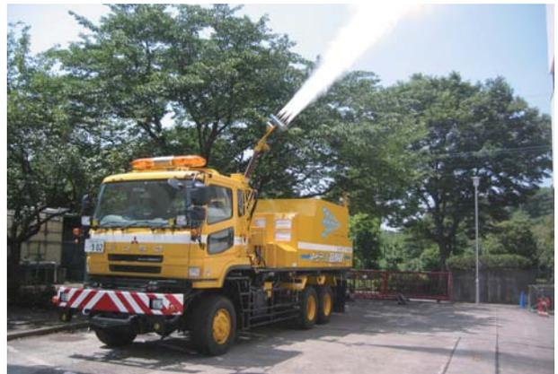
⑥ キャビテーション噴流技術を用いたトンネル照明器具の高速清掃装置の開発
