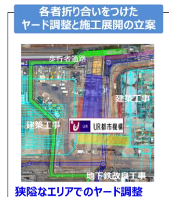
図-7 ヤード調整・施工展開イメージ
