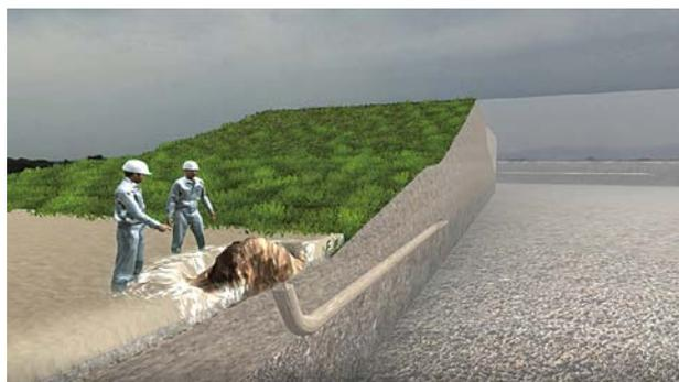
浸透破堤体験コンテンツによる変状解説（噴砂を再現）
