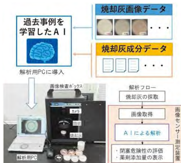
画像センサー測定装置と解析フロー
