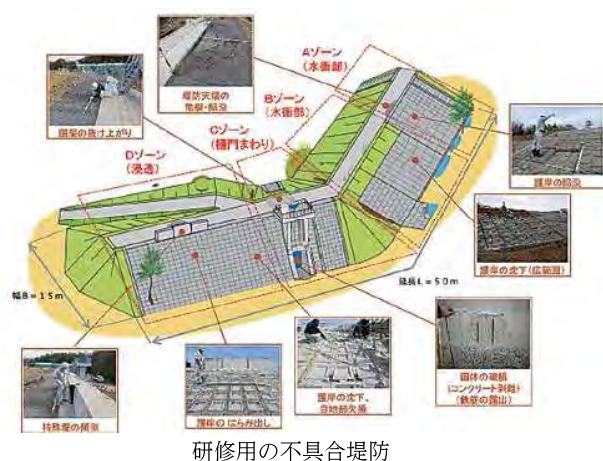
研修用の不具合堤防
