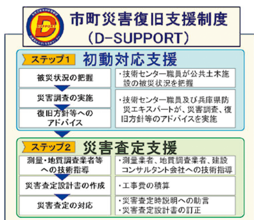
市町災害復旧支援制度 (D-SUPPORT)の流れ
