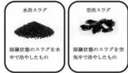
栃木県下水道資源化工場で生成されるスラグ
