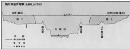
昭和36年6月洪水後の治水対策（超越堤防式）
